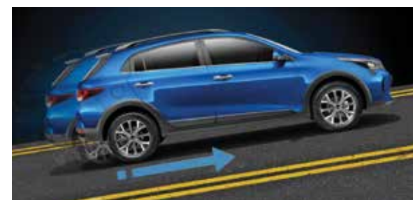
Система помощи при старте на подъеме (НАС) Когда вы трогаетесь с места на подъеме, система удержит тормоз в течение двух секунд, чтобы предотвратить откатывание назад.
