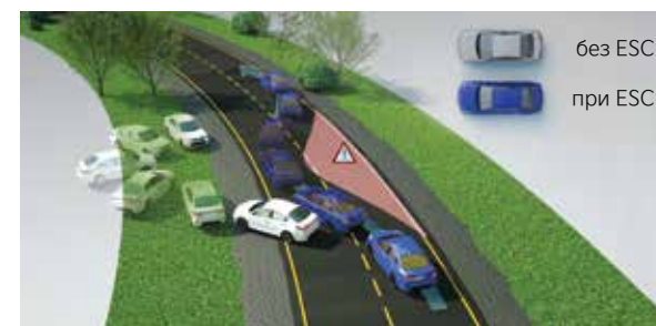
Система курсовой устойчивости (ESC) Помогает сохранить траекторию движения в ситуации возможного заноса за счет автоматического притормаживания одного из колес.
