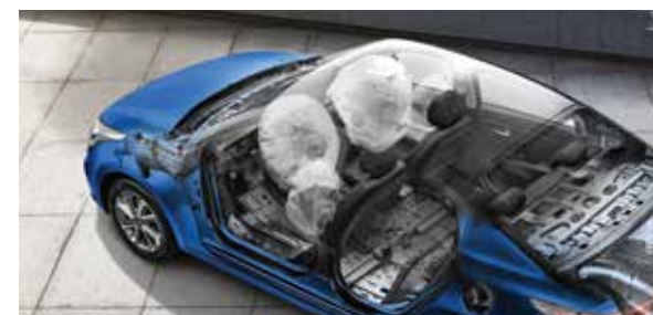
6 подушек безопасности Две передние и две боковые подушки для водителя и переднего пассажира, а также две боковые шторки по всей длине салона.
